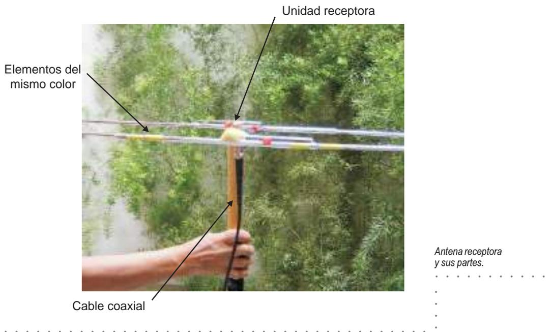
Seleccione la frecuencia del animal que vaya a localizar en el radioreceptor. Para esto tenga en cuenta que usted debe sintonizar los últimos tres dígitos de la frecuencia. Por ejemplo, si la frecuencia es 217.024 MHz, usted debe colocar en Canales (o *Channel*) los números cero (0) y dos (2) y en el Sintonizador el cuatro (4). El número 217 no se ubica en el radioreceptor porque el equipo está programado para recibir sólo en este rango de frecuencia.
